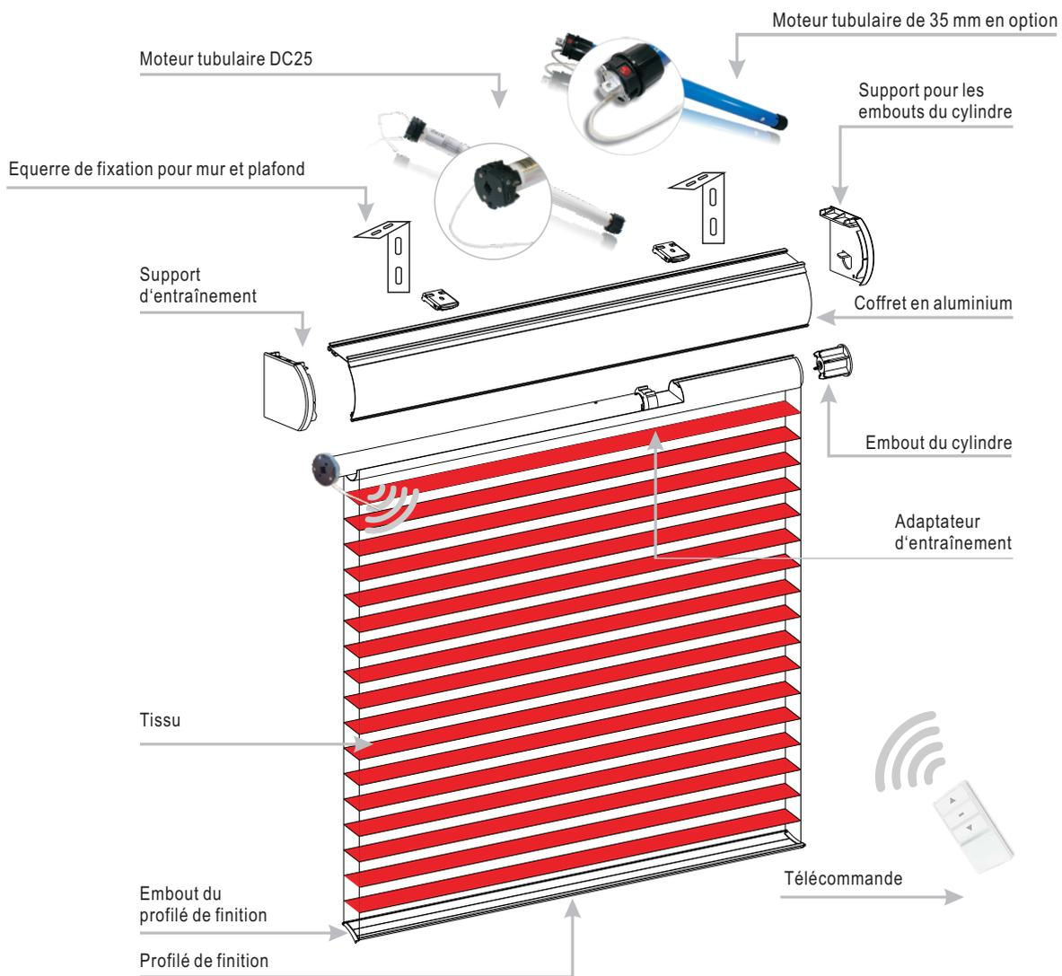
coffret Ø 38mm axe rond pour moteur de Ø 25 mm
