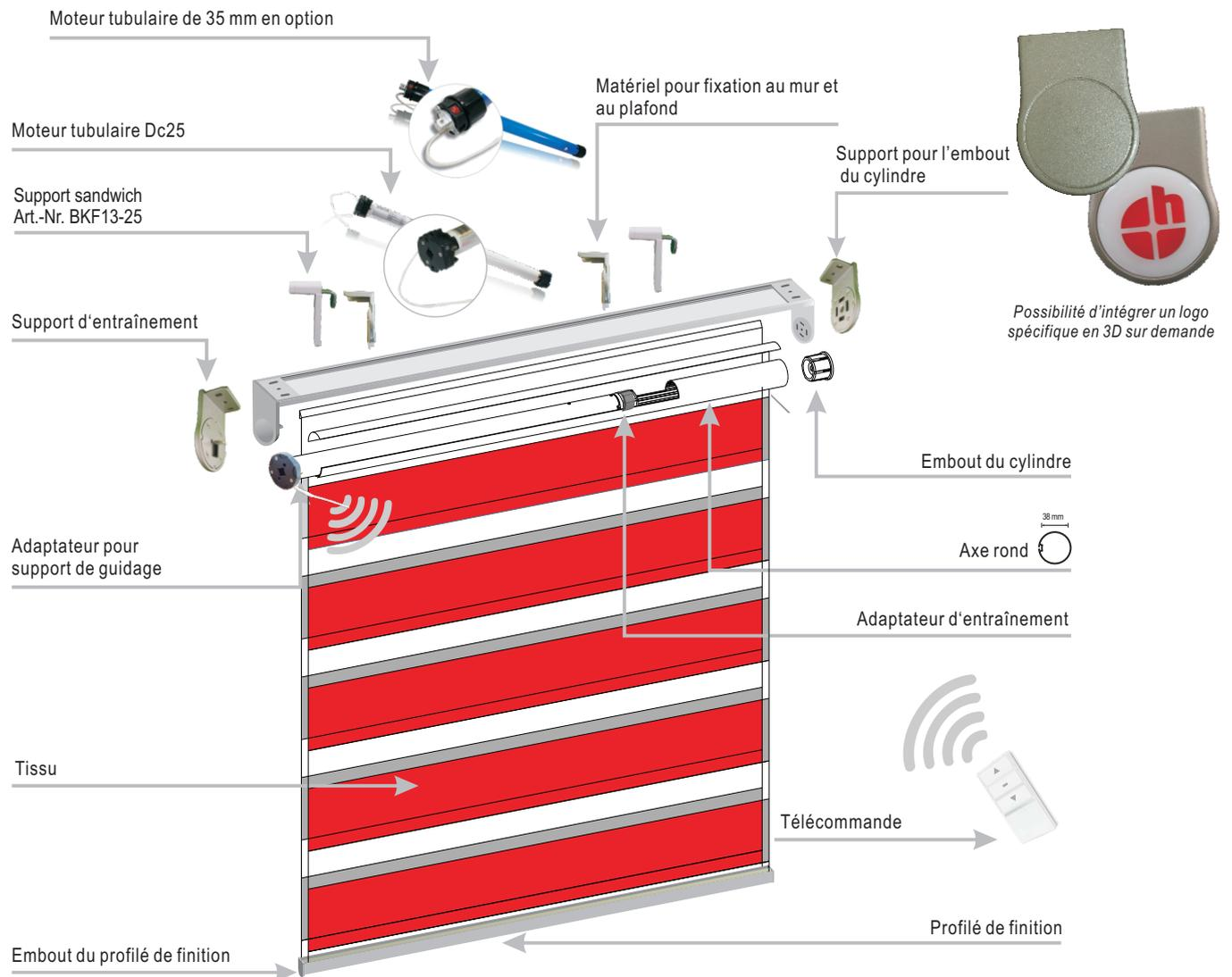
Rail standard pour moteur  $\varnothing 25\text{ mm}$
