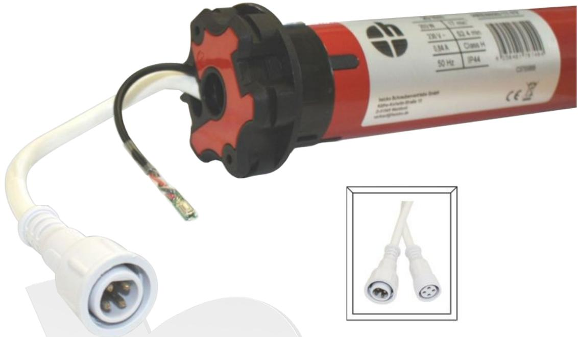
Sulla testata del motore è presente un cavo lungo 15 cm con connettore a quattro poli (con dado e guarnizione). È disponibile anche un cavo di alimentazione da 185 cm con accoppiamento a quattro poli, in modo che la lunghezza totale del cavo sia di 200 cm. Questo plug-in corrisponde al grado di protezione IP44. In opzione offriamo su richiesta prolunghe di qualsiasi lunghezza.
